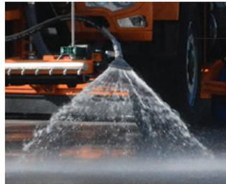
*Hochdurchflusseitige Düsen können am linken und rechten Ende der Rampe montiert und einzeln über das Hydrauliksystem geleitet werden*
