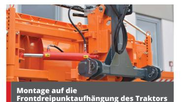
Neben der Möglichkeit die Frontanbauplatte am Traktor zu montieren, können die RASCO Schneepflüge auch einfach auf die Frontdreipunktaufhängung des Traktors, wenn dieser damit ausgestattet ist, montiert werden.
