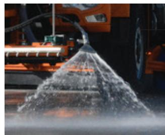
*Bočne mlaznice visokog protoka moguće je ugraditi na lijevi i desni kraj rampe te ih individualno usmjeravati putem hidrauličkog sustava*
