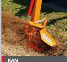
Der KAN ist ein Kanalreiniger, der zum Reinigen und Profilieren von Kanälen entlang von Straßen entwickelt wurde.
