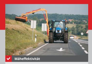
Die BRKT ist seitlich zwischen Vorder- und Hinterachse des Traktors montiert. Dadurch erhält der Fahrer eine hervorragende Sicht bei der Arbeit, eine leichtere Vermeidung von Hindernissen (Verkehrszeichen usw.) und eine kompromisslose Sicherheit und Stabilität des Mähers.
