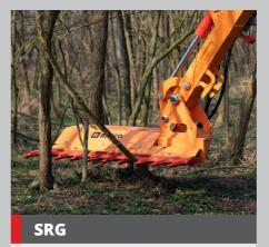
Die SRG sind Astscheren in den Breiten 1.4, 1.8 und 2.0 m erhältlich, die speziell zum Entfernen von Baumkronen, Gestrüpp und kleinerer Vegetation mit einer Dicke von bis zu 100 mm entwickelt wurden.
