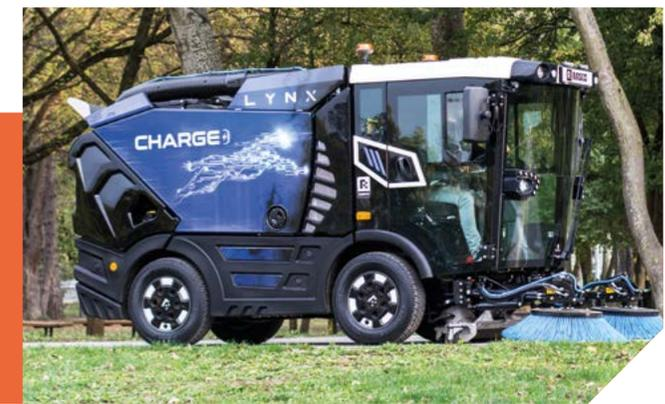
Beide Kehrmaschinen verfügen über ein Wasserrecyclingsystem, das einen reibungslosen Fluss des gesammelten Materials und zusätzliche Staubbindung gewährleistet. Diese Funktion spielt eine entscheidende Rolle beim Einsparen von Frischwasser und trägt zum nachhaltigen Betrieb der Kehrmaschine bei. Die Kehrmaschinen sind darauf ausgelegt, Staubentwicklung optimal zu unterbinden (PM 10/2.5 zertifiziert), was zu einer besseren Luftqualität beiträgt.
