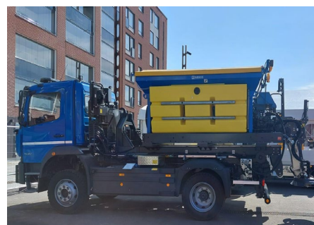
Die Montage an Fahrzeuge, die mit einem Hakenlift-System ausgestattet sind
