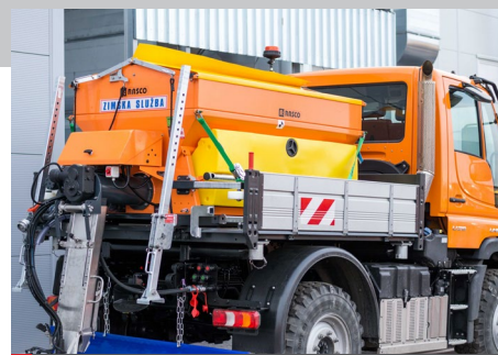
Die Montage an die Kugeln des Kippkastens
