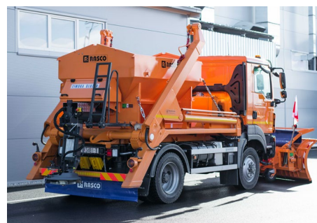
Die Montage an Fahrzeuge, die mit einem Containerlift ausgestattet sind
