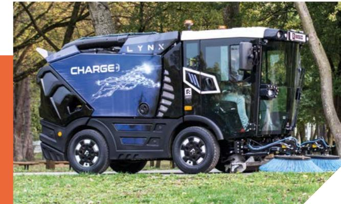
Lynx kompaktne vakumske čistilice ne samo da imaju malu emisiju štetnih plinova i malu potrošnju vode, već imaju i minimalno zagađenje okoliša bukom. Dizelski motor Lynxa 2000 i električni pogonski sklop Lynxa Charge 2000 rade tihu i idealni su za upotrebu u stambenim i na buku osjetljivim područjima.
