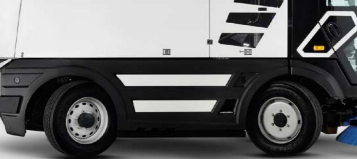
na stražnjoj osovinu, omogućuje brzo kretanje između odredišta što doprinosi učinkovitijem čišćenju. Sustav upravljanja na četiri kotača (4WS), omogućuje precizniju kontrolu i upravljanje tijekom rada te se automatski isključuje u transportnom načinu kako bi vozilo ostalo stabilno čak i pri visokim brzinama.
