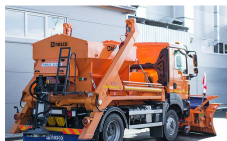
Ugradnja na vozila opremljena podizačem kontejnera
