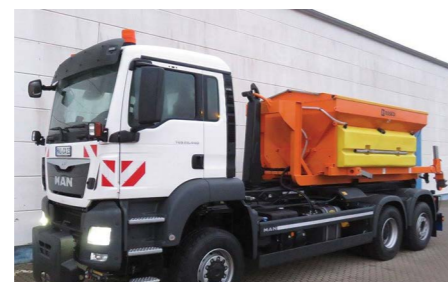
Ugradnja na vozila opremljena hooklift sustavom
