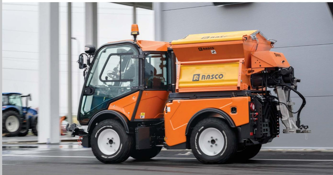
Pužni transporter je najbolji izbor za posipanje materijalima poput fine soli s malim udjelom vlage ili kamenim granulatom. Ako je posipač opremljen sustavom za mokro posipanje, suho sredstvo se može miješati s otopinama klorida čime se povećava učinkovitost posipanja.
