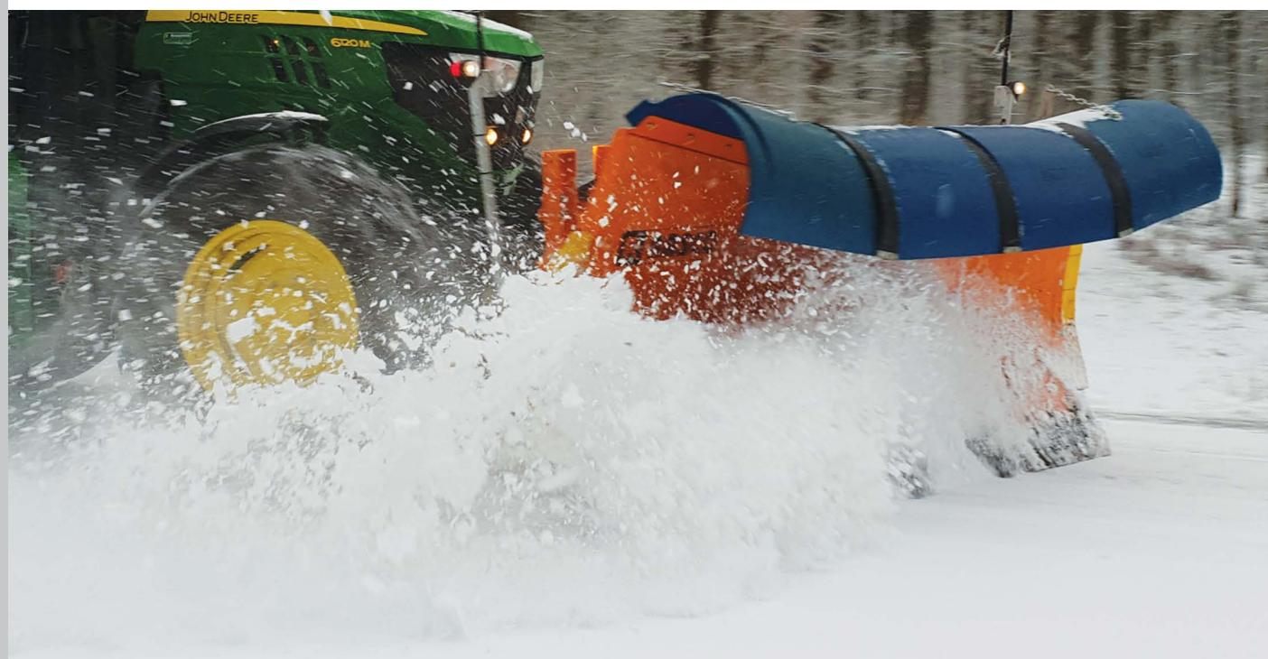
Robusna protusnježna zaštita štiti od prštanja snijega na vjetrobransko staklo vozila te omogućava neometano čišćenje snijega pri većim brzinama.
